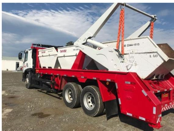
Figura 4 – Caminhão utilizado para realização das coletas.
