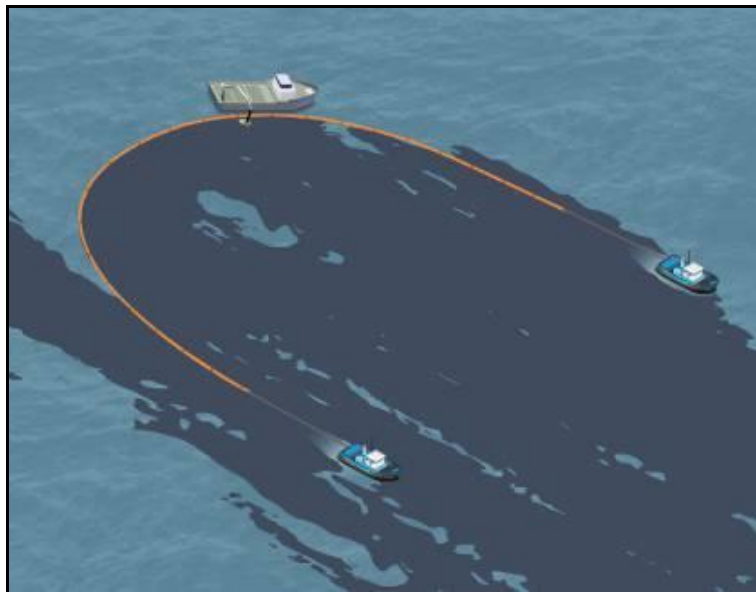
Figura 12. Formação "U", com aporte um uma embarcação para recolhimento do óleo contido.
