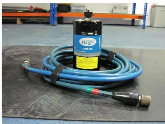
Figura 19. Compensador de movimentos TSS/DMS-25.
