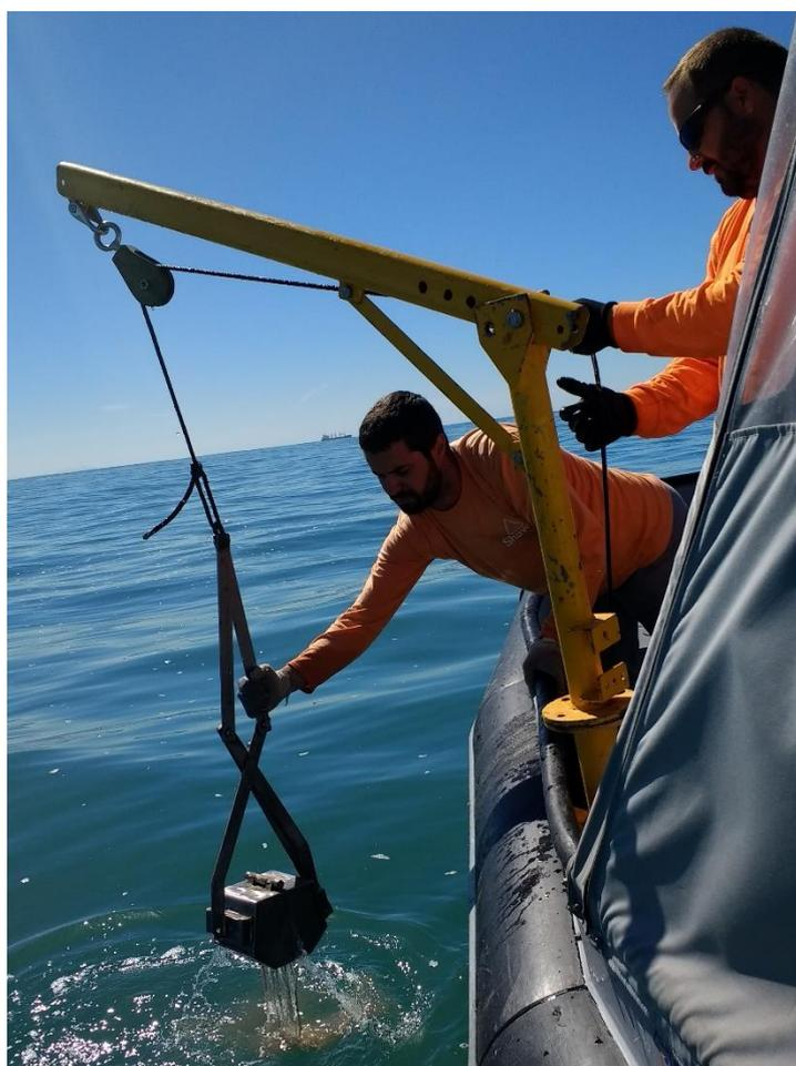
Figura 38. Coleta de sedimentos usando draga tipo “Van Veen”.
