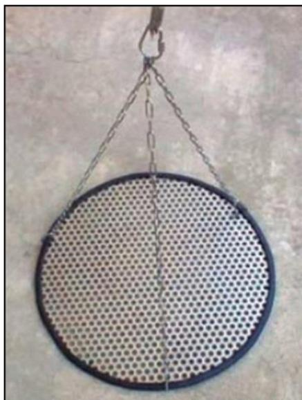
Figura 21. Disco de aferição do transdutor do ecobatímetro (*barcheck*).
