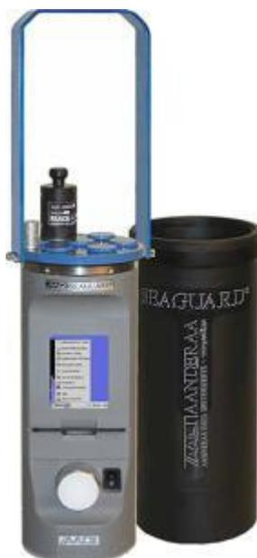
**Figura 27. Marégrafo modelo Seaguard WLR.**
